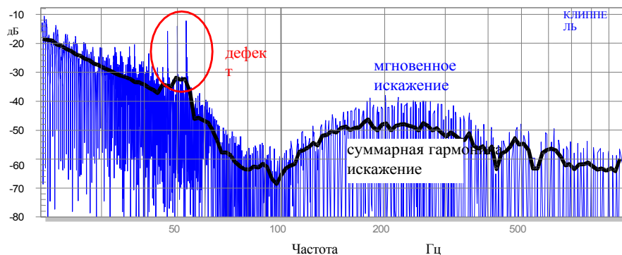
Рисунок 19: Мгновенные искажения IHD и суммарные гармонические искажения THD в выходном звуковом давлении, измеренные с помощью синусоидальной развертки на неисправном громкоговорителе.
